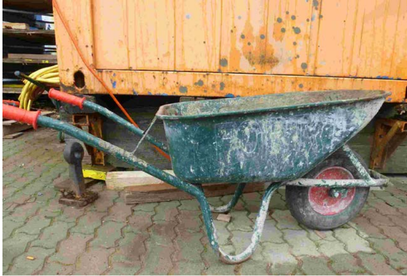
Schubkarre mit Scheibenrad, Tragkraft 160-220 kg bei einem Preis von 55-70 Euro
