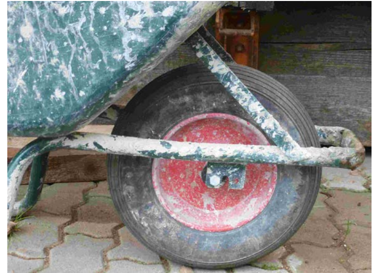
Schubkarre mit Scheibenrad, Tragkraft 160-220 kg bei einem Preis von 55-70 Euro
