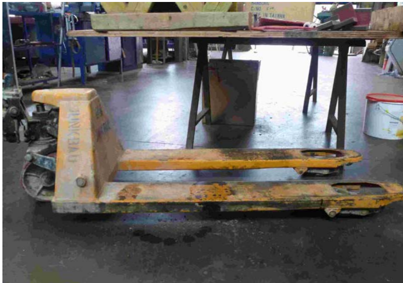
Manuell zu bedienender Gabelhubwagen mit Scheibenrädern, bis zu 2500 kg Tragkraft bei einem Preis von ca. 600 Euro
